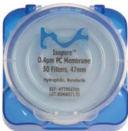
Membran aus Polycarbonat, lichtdurchlässig für mikroskopische Beobachtungen.
