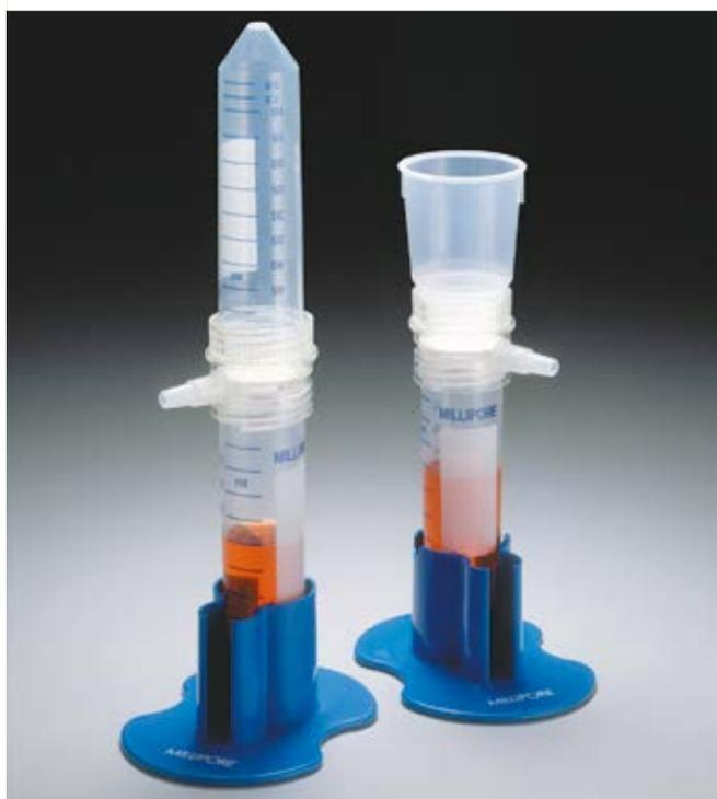
Zum Vakuumfiltrieren von Volumina unter 50 ml.
