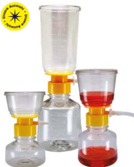
Filtereinheiten und Bottle-Tops für die Vakuumfiltration. Ideal für die Trennung und Reinigung von Proben. Große Auswahl an Membranen: Porengröße 0,22 oder 0,45 µm, aus Zellulose-Mischestern (MCE), Nylon, PVDF und PES.
